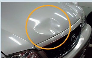
■ サッカーボール大程度のへこみ ≫ 査定減点40点相当
