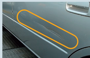
■ サッカーボール大程度のキズを 伴うヘコミ ≫ 査定減点40点相当
