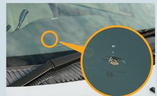
■ 1cm程度の割れまたは補修跡 ≫ 査定減点50点相当
